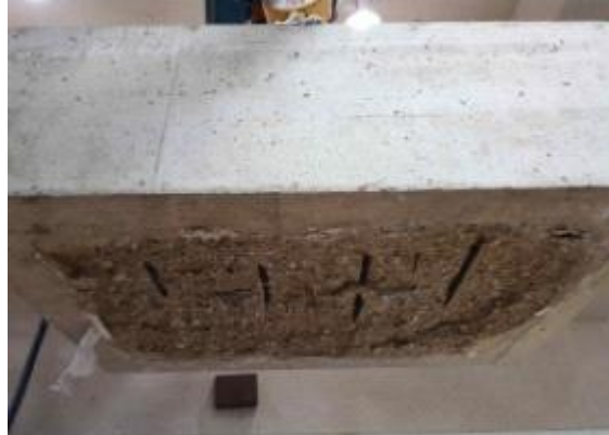
(a) 내화 시험 전 시험체 표면 (b) 내화 시험 후 시험체 표면 해설 그림 5.3 내화시험 전·후 시험체 표면 사례
