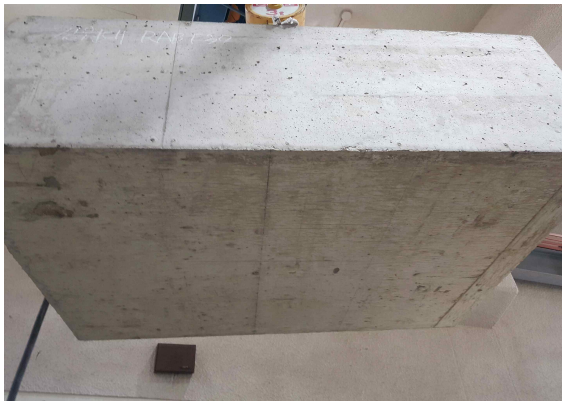
(a) 내화 시험 전 시험체 표면 (b) 내화 시험 후 시험체 표면 해설 그림 5.3 내화시험 전·후 시험체 표면 사례
